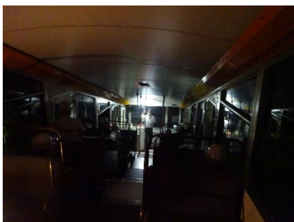
変電所事故を想定し車両内照明が電断した状況にて、車掌により避難救助案内を実施
